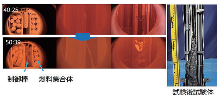
図13 試験状況及び試験後試験体
