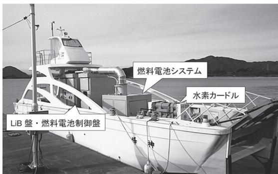
図3 燃料電池システムを搭載した小型実験船「神峰」
