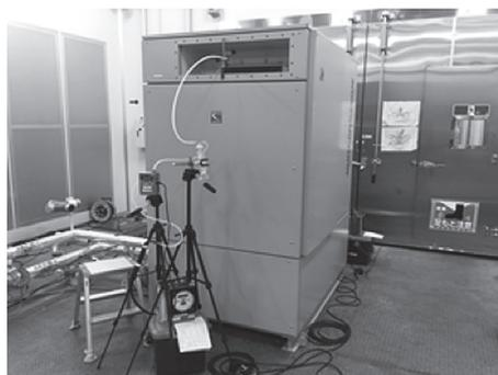
図3 液式デシカント装置(再生機)
