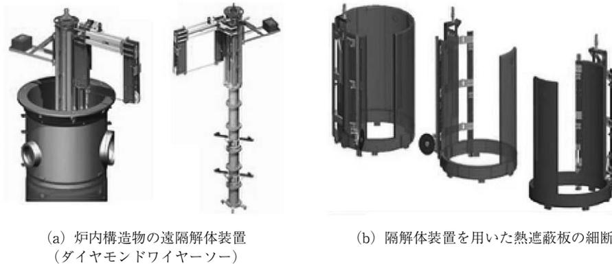
図5 ダイヤモンドワイヤーソーを用いた炉内構造物の遠隔解体装置
