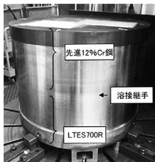
図 6 LTES700R と高 Cr 鋼（先進 12%Cr 鋼）の溶接施工例
