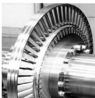
図8 Ni 基合金によるタービンロータ製造例
