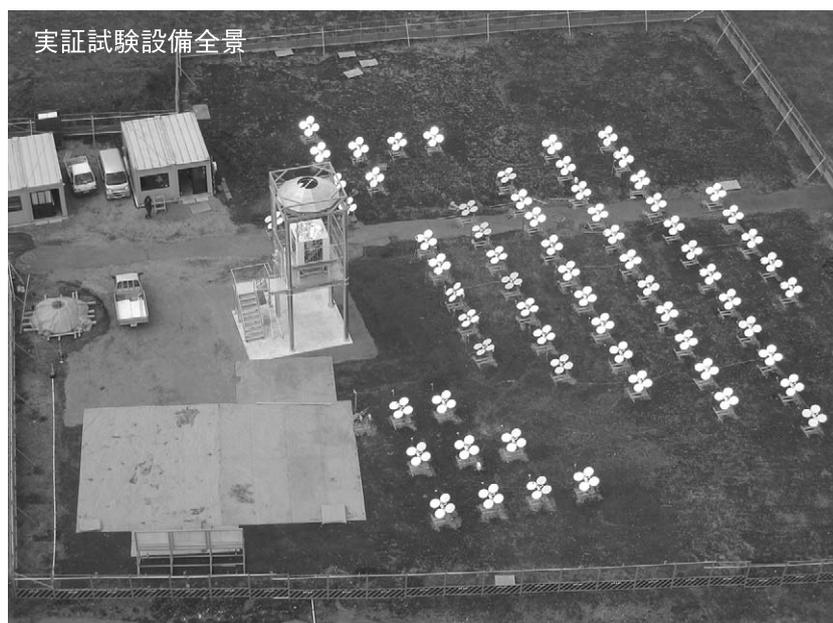
タットの鏡でした。遠くから見ると可愛らしく見えたヘリオスタットですが、高さ1.5mのところに直径50cmの鏡が4枚並び、結構、迫力があります。
