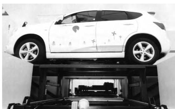
図13 Better Place社の電池交換システム
