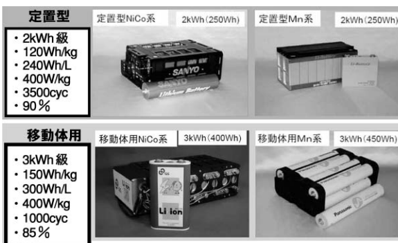
図10 NEDOプロジェクトで開発したモジュール (1)
