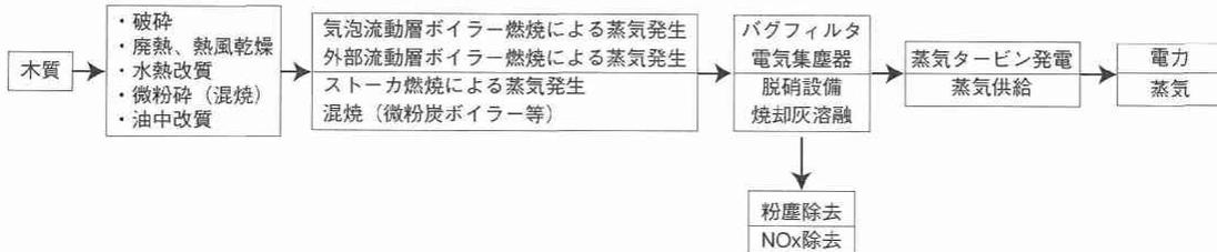
図4 エネルギー転換技術システムフロー図の例(木質—直接燃焼—電力)
