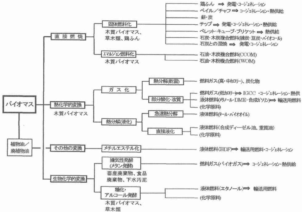
図2 バイオマスのエネルギー変換・利用方式
