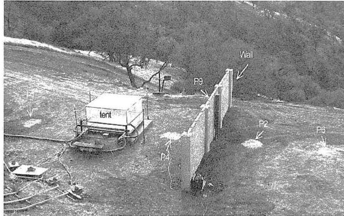
図1 解放空間での爆燃装置（ 5.2\text{m}^3 ）と防爆壁 (2)
