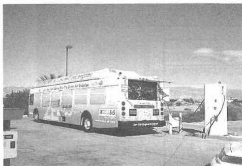
水素ステーションと水素充填中の燃料電池バス
