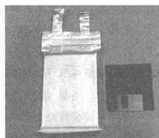
図10 新しい炭素材料を用いた高エネルギー密度キャパシタ
