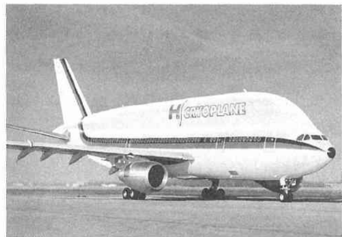
図5 エアバスA310をベースとした水素飛行機
