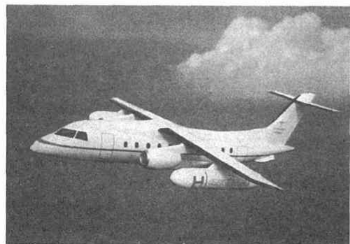
図6 ドルニエDo328をベースとした水素飛行機
