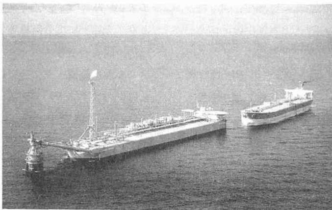
注：左側の船が現存の油 FPSO 船、甲板上右舷側が油生産装置、左舷側がメタノール製造装置が設置できる空きスペース。右側の船が輸送用タンカー
