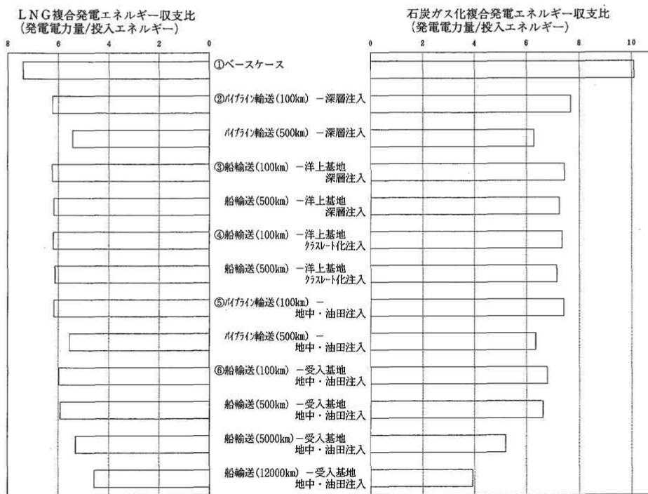
図 4 回収 CO<sub>2</sub> 輸送・処分別エネルギー収支比
