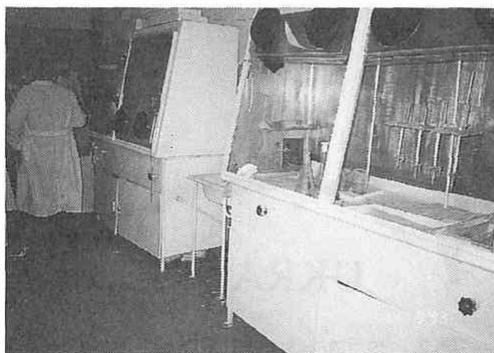
写真4 グローブボックス内での放射性核種の分離
