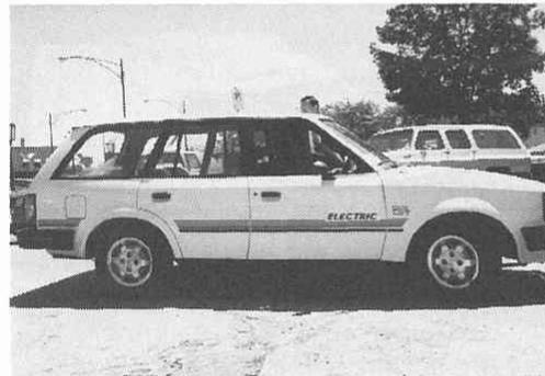
写真1 Gel-Cell電池を搭載したフォード・エスコートの改造車（ソレック）
