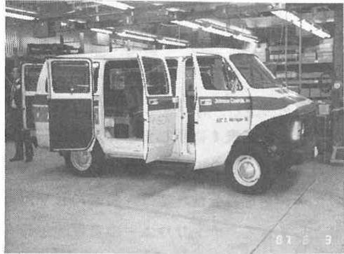
写真5 Zn-Br電池を搭載し実証試験中の状況
