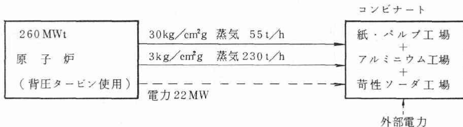
図1 中小型軽水炉熱利用システム (その1 産業用利用)
