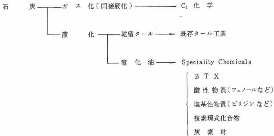
図2.4 石炭の化学原料化
