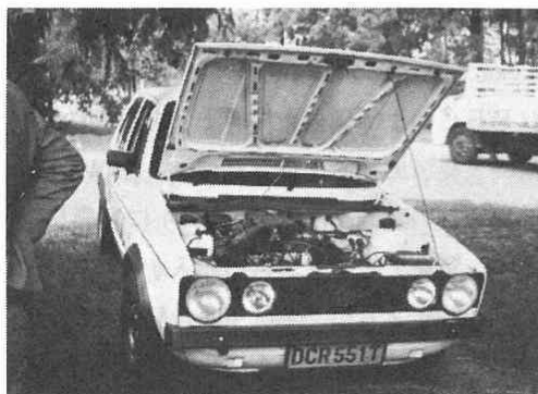
写真4 メタノール車 (M-100) 補助タンクからのガソリンで始動し、その後メタノールに切替える
