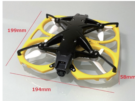
図2 狭小空間専用ドローン「IBIS2」の外観
