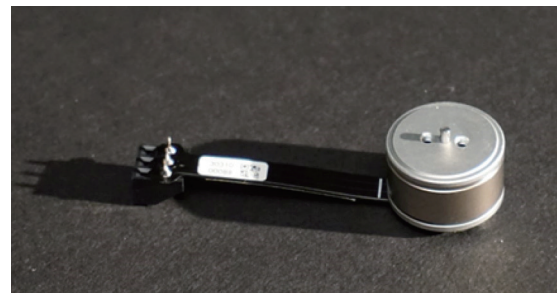
図5 密閉型防塵モーター
