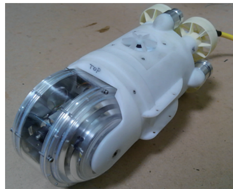
図7 水中遊泳型ロボット
