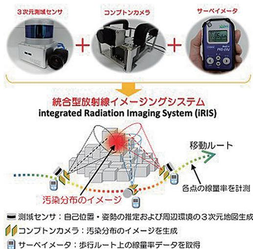
図 17 統合型放射線イメージングシステム（iRIS）の概念
