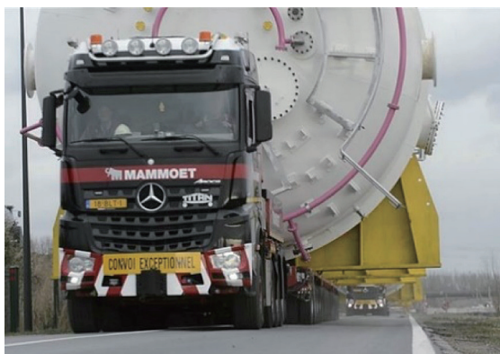
図8 運搬中の Steelanol 発酵槽
