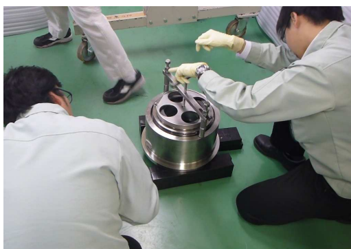
—メカニカルシール組立風景—
