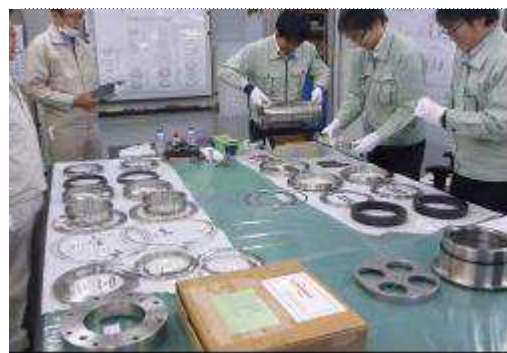
—メカニカルシール組立風景—
