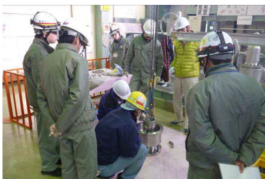
メカニカルシール分解・組立（実習） 受講者によるメカニカルシール分解
