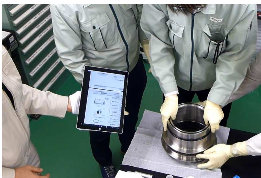
—メカニカルシール組立風景—
